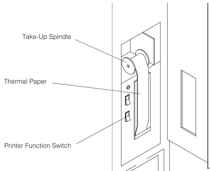
**Figure 3-4. Printer Components**
